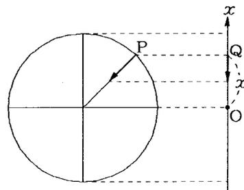
このように、加速度はどの場所をとっても振動の中心点  $O$  を向いている。加速度の大きさは変位  $x$  に比例している。
