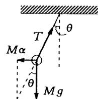
(2) 右の図に示すように、等加速度運動をしている電車内では慣性力  $M\alpha$  と重力  $Mg$  の合力である見かけの重力がはたらいているように見える。これより見かけの重力加速度  $g'$  を求めると、
