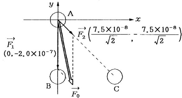
図のように、 $xy$  座標を決めて、(1)、(2) で求めた力をベクトルで表す。この2つのベクトルを合成したベクトルの大きさが求める力になる。
