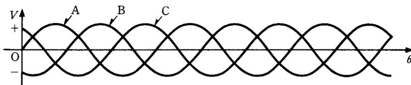
これは、三相交流と呼ばれるもので、発電機の軸の回転という運動エネルギーが電気エネルギーに変換されている例です。
